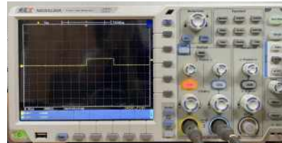
[그림 20] 초음파 센서 5cm 거리 약 300us
