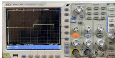
[그림 19] 초음파 센서 10cm 거리 약 590us
